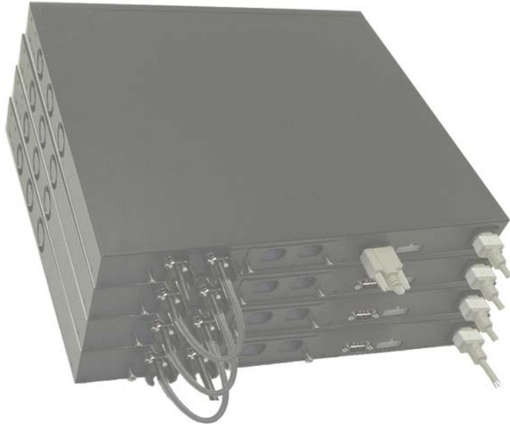
Rysunek 1-3. Łączenie wieży przełączników
