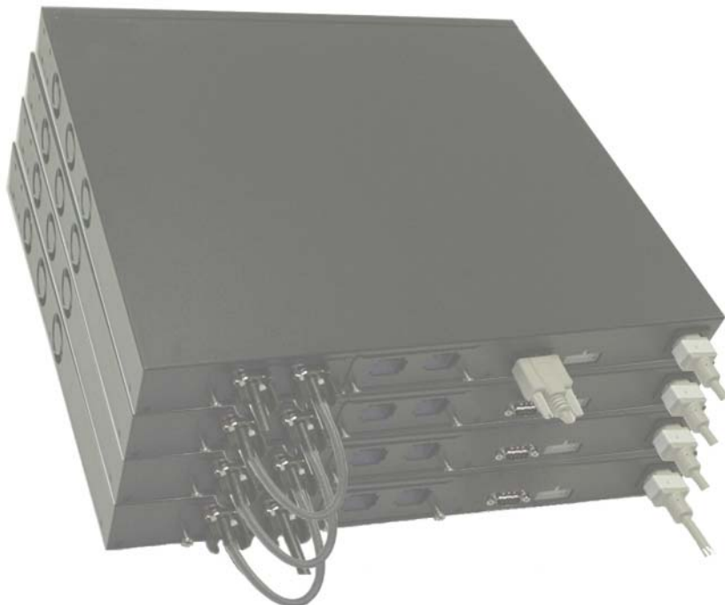
Obr. 1-3. Propojení stohu přepínačů
